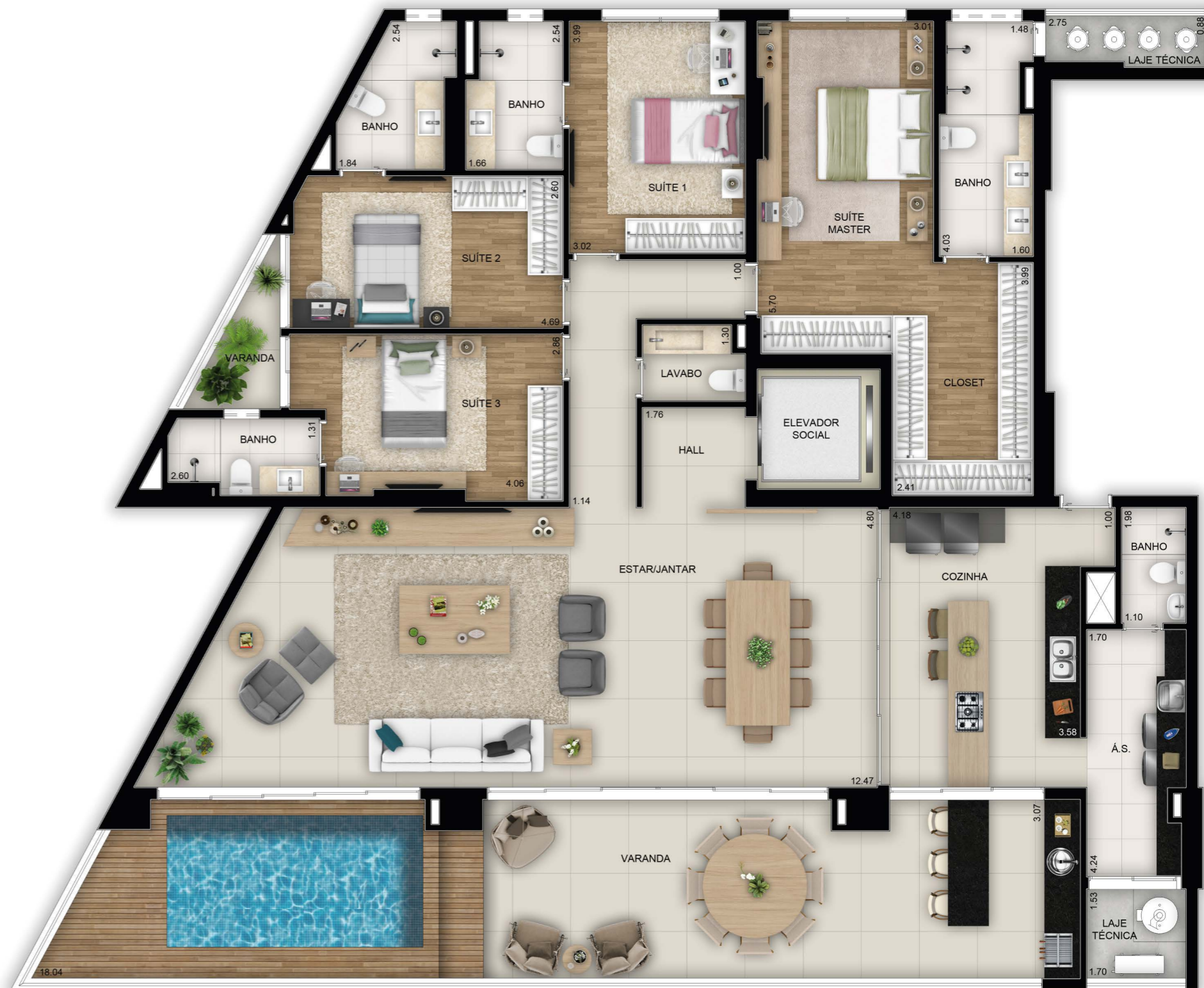
Piscina com 4,48m x 2,24m - 84cm de profundidade sendo 76cm de lâmina d'água
